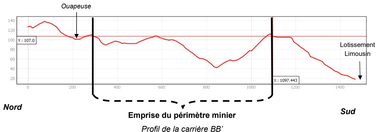
Figure 27 : Coupes topographiques illustrant l'encaissement de la carrière
