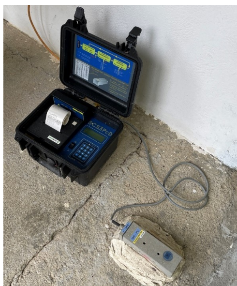
Exemple de pose d'un sismographe.
